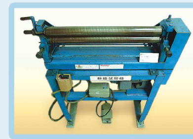
▲折腰試驗機 Bending test machine 廠牌(Brand)：商寶機械
