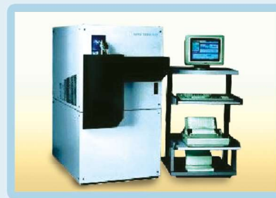
▲分光儀 Spark analyzer 廠牌(Brand)：SPECTRO
