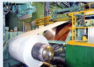
▲ 出口上下雙向收捲機 Exit Top/Bottom Tension Reel
