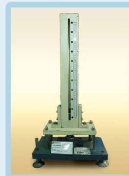
▲衝擊試驗機 Impact test machine 廠牌(Brand)：弘達儀器 Hung Ta
